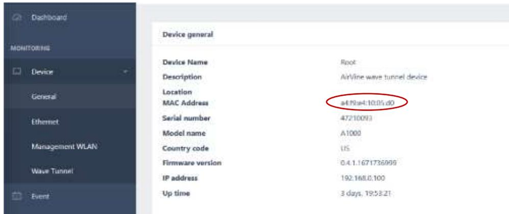
2. Ingrese al equipo WaveTunnel™ que será configurado utilizando ya sea el navegador o la aplicación AirvineMobile App con las siguientes credenciales **UN=admin PW=admin** para el navegador. La contraseña del SSID para la aplicación móvil utilizando la interfaz inalámbrica es = **airvine!**
