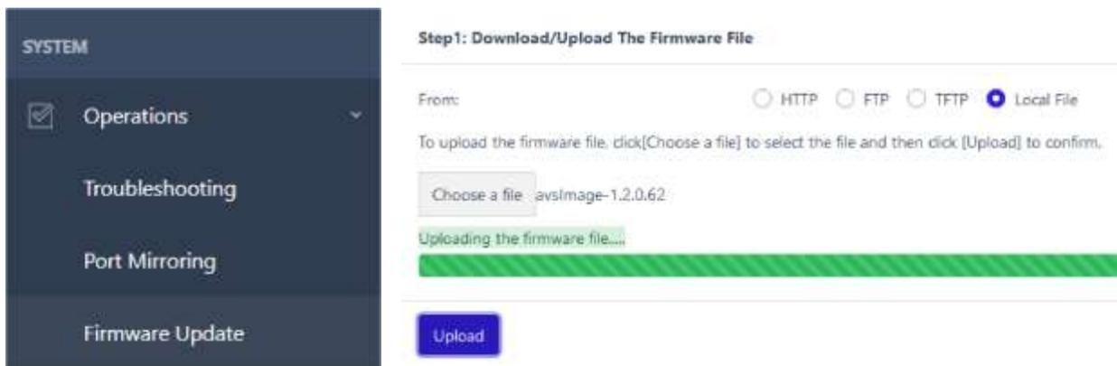
Desde la sección de **Sistema > Actualización de firmware** seleccione el firmware recientemente descargado y cárguelo al equipo WaveTunnel™. La forma más sencilla es a través del método de carga local. Una vez finalizada la carga, presione el botón “escribir” y deje que el sistema se actualice y se reinicie.
